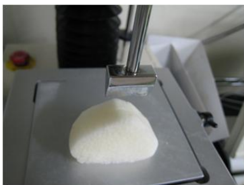
図6. テクスチャーアナライザーを用いた物性測定
