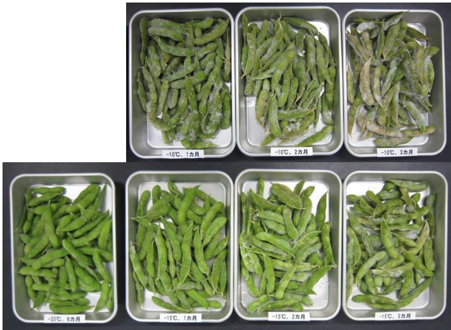
図 7. 冷凍保存温度別のサンプル（表面に発生した氷結晶の様子）
